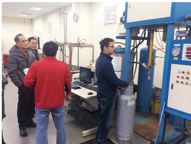
圖 4-3-3 鋼製液化石油氣容器個別認可抽驗情形（耐壓試驗）
