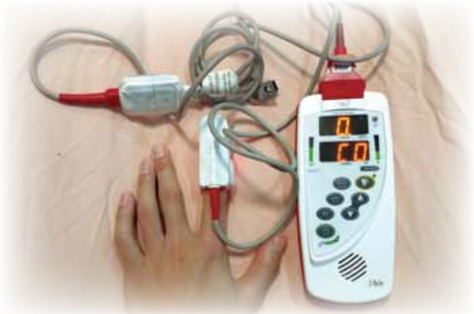
■一氧化碳血氧濃度測定儀可測出患者體內一氧化碳濃度。
