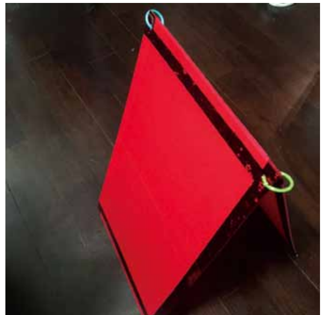
■板子上方左右打洞並套上扣環。
