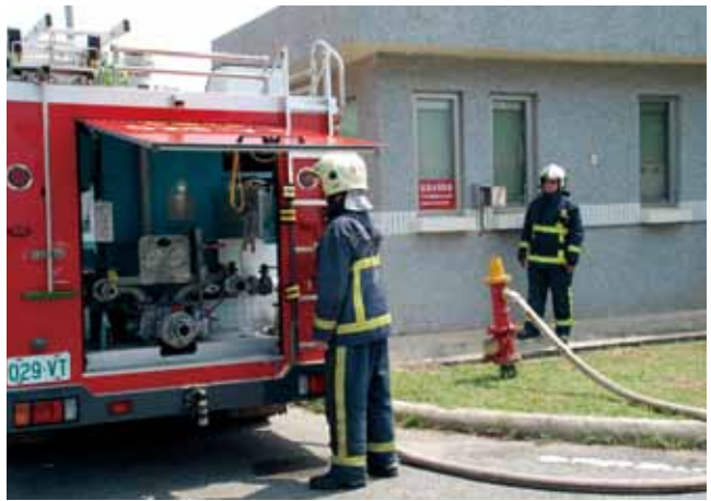
■消防車使用放流水加水情形。
